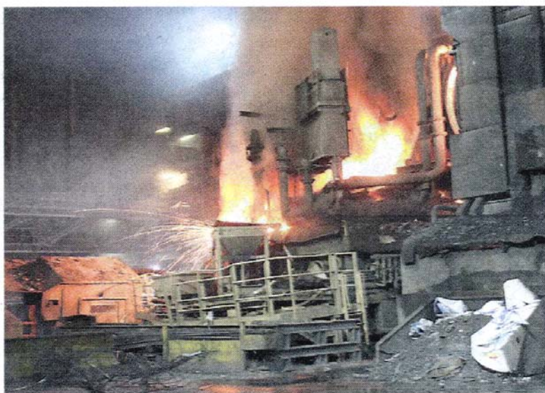
Le haut-fourneau électrique chauffe l'acier à 1 600 degrés.
